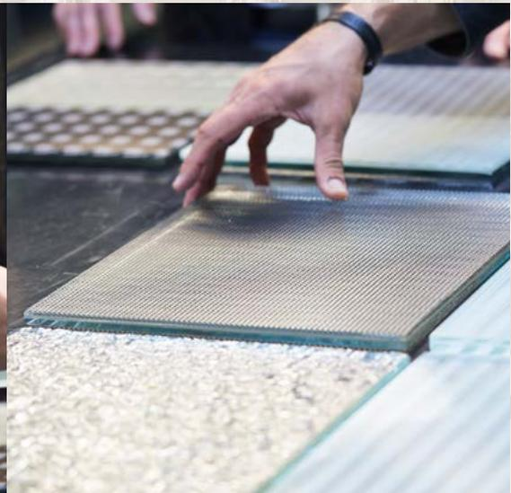
Satiniertes Glas auf der einen Seite, strukturiertes Gussglas auf der anderen. Das eine streut sanft das Licht, wirkt wie ein Weichzeichner, das andere bricht das Licht durch seine markante Struktur und hat eine eher raue Ausstrahlung. Zu einem Glas vereint, entfaltet dieses eine neue, überraschende Qualität. Und ist nur eine Möglichkeit von vielen, mit den unterschiedlichen Qualitäten von Glas zu experimentieren.
